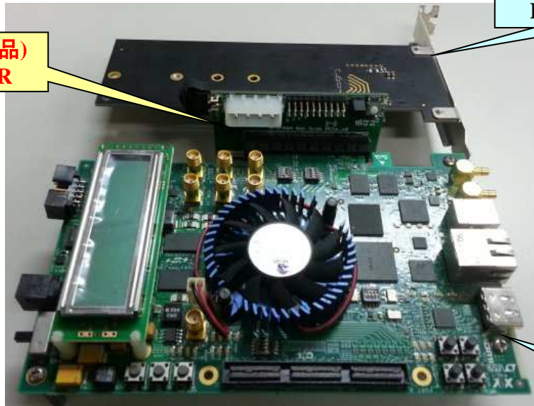
ArriaV GXスタータキットでのIPコア実機評価環境
