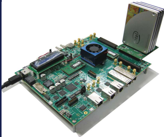
アルテラ®Arria® 10 SX FPGA開発ボード + DG製SATA-FMCアダプターボード (AB09-FMCRAID) + SATA-III SSD x 4ch RAID評価
