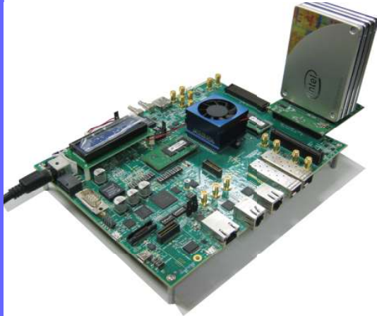
Arria 10 SX FPGA開発ボード + DG製SATA-FMCアダプタボード + SATA-III SSD x 4ch RAID評価
