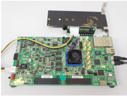
KCU105 ボード+ Samsung SSD 960 Pro での評価
