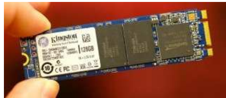
Latest M.2 type PCIe SSD
