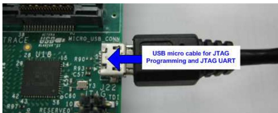
図 2-7: マイクロ USB ケーブルの接続
