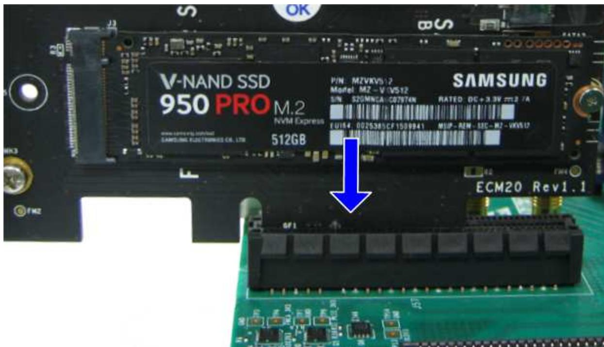
図 2-6: NVMe PCIe SSD と Arria10 SoC 開発キットの接続
