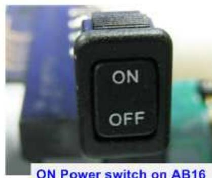
図 2-5: FPGA 評価ボードと AB16-PCIeXOVR アダプタの電源を投入
