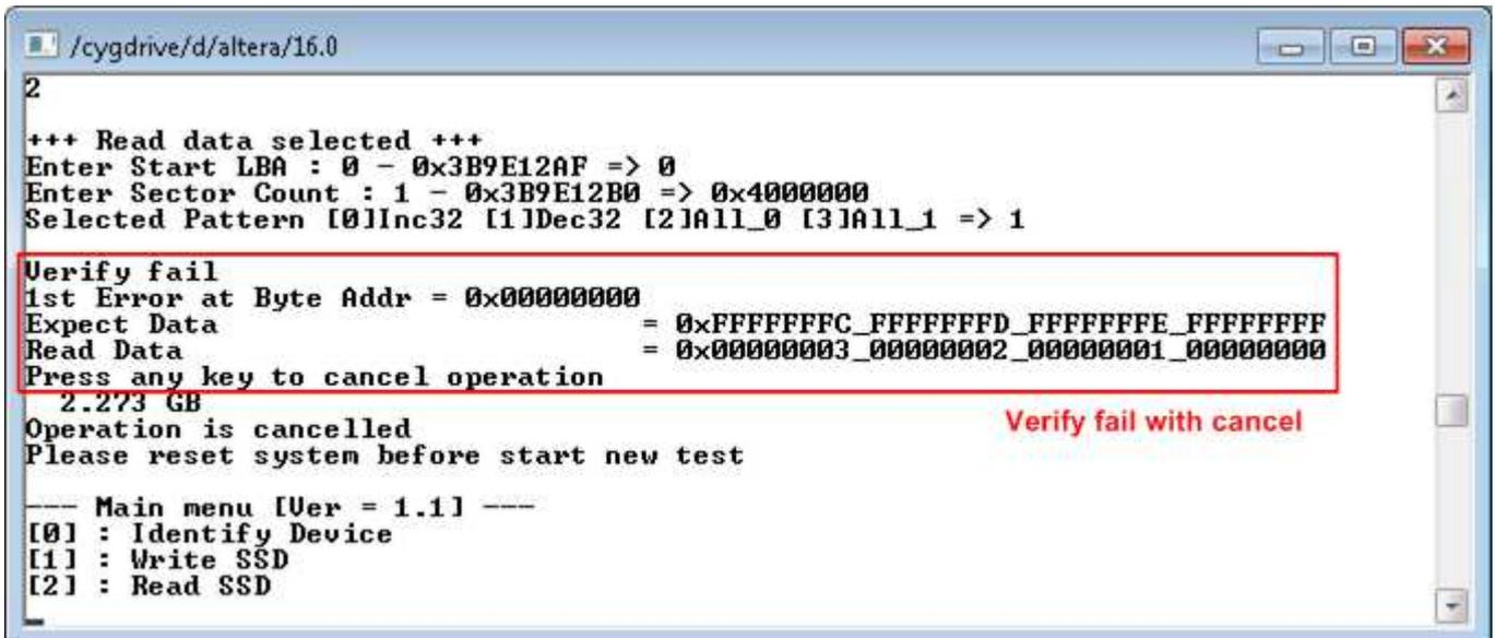
図 3-10: リード時ベリファイでエラーが発生しユーザがキャンセルを指示した場合の結果例
