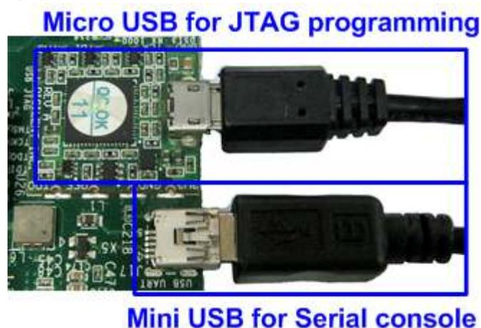
図 2-9: JTAG 接続用および USB シリアル接続用の 2 本の USB ケーブル接続
