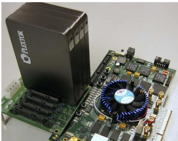
FPGA開発ボードを使ったSATA-IP RAIDシステム
