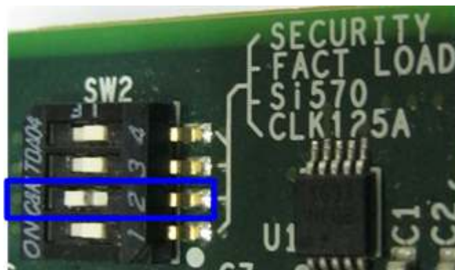
図 1-7 CycloneV SX SoC 開発キットの場合 SW2 の Bit2 を ON
