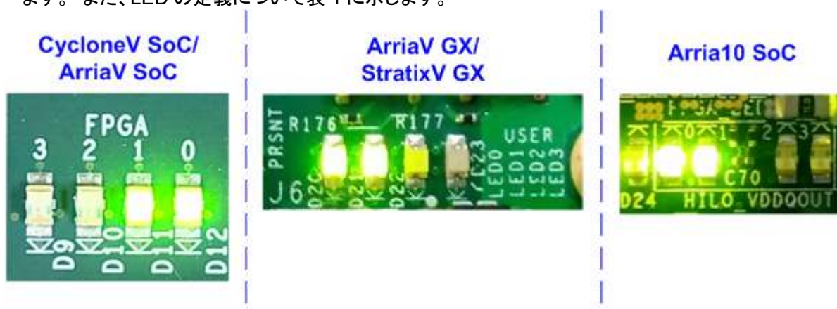
図 1-16 セットアップ完了時の LED の状態
