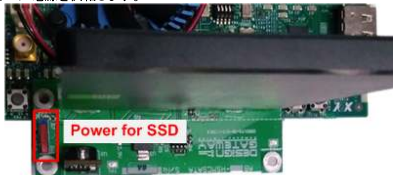
図 1-14 AB11-HSMCSATA アダプタの SATA デバイス用電源スイッチを ON とする
