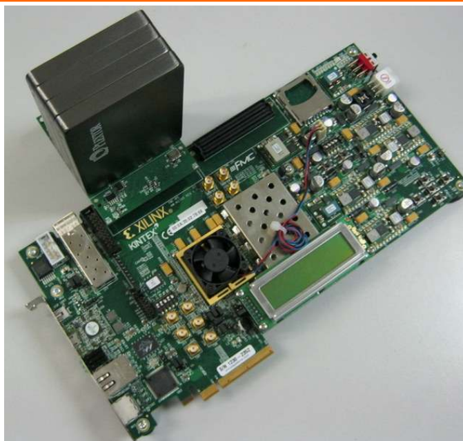
FPGA開発ボードを使ったSATA-IP RAID試作システム
