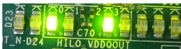
図 4-8: DIPSW[0]='1'(ジャンボ・フレーム)とした場合のスタート SW 押下後の LED 点灯状態
