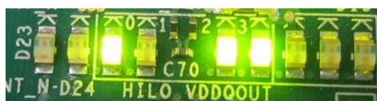
図 4-12: ジャンボ・フレームの送信中の LED 状態
