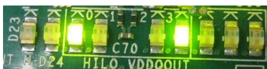
図 4-10: 非ジャンボ・フレームの送信中の LED 状態
