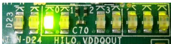
図 4-7: DIPSW[0]='0'(非ジャンボ・フレーム)とした場合のスタート SW 押下後の LED 点灯状態
