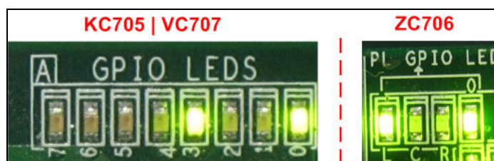
15: 非ジャンボフレームの送信中の LED 状態
