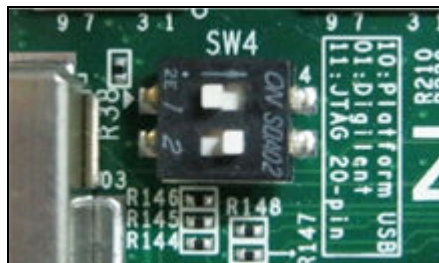
図 10: ZC706 の場合 SW4 を”10”とし Platform USB を選択
