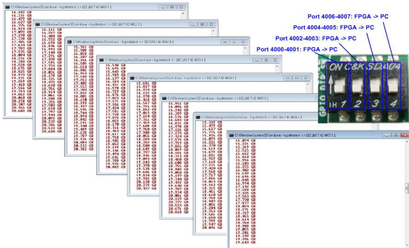
図 4-2: 同時 8 セッションの送信テスト(PC 側では 8 個の DOS 窓でそれぞれのポートでのセッションを実行)
