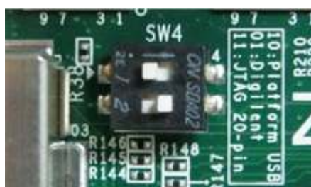
図 3-3: ZC706 ボードの場合 USB からの JTAG アクセスを設定します
