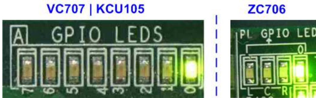
図 3-8: スタート SW 押下後の LED 状態
