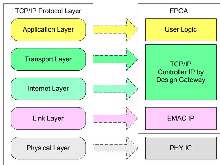
図 1: TCP/IP プロトコルのレイヤ図
