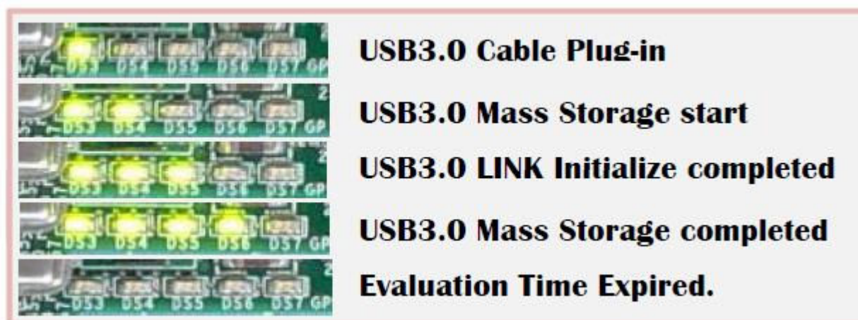
図 12: Mass Storage Class 正常起動時の LED 点灯状態
