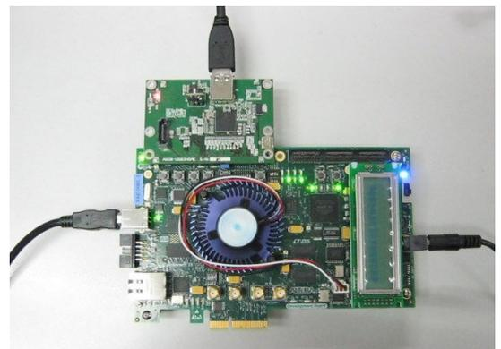
CycloneIV GX FPGA 開発キットで USB3.0(デバイス)-IP コアを評価
