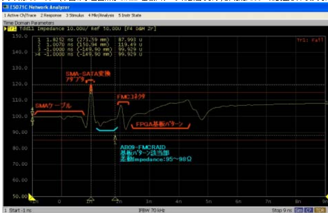
図 4: AB09-FMCRAID 基板の差動インピーダンス実測値 (CH#3)
