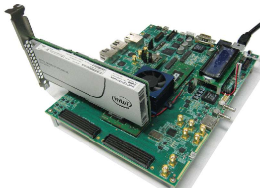
インテル® Arria® 10 SX SoC FPGA開発ボード + インテル® NVMe PCIe SSD での評価
