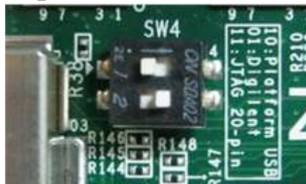
図 2-2: ZC706 では SW4 を”01”として USB から JTAG チェーンを接続する設定
