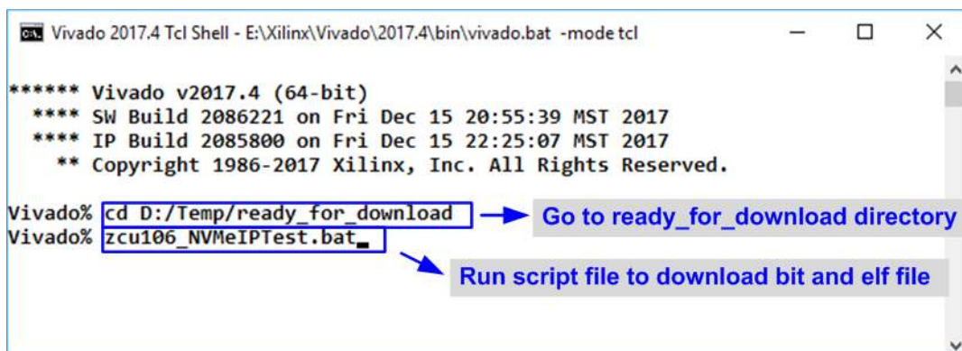
図 2-10: ZC706/ZCU106 では Vivado TCL シェルのコマンド・スクリプトで FPGA をコンフィグレーション
