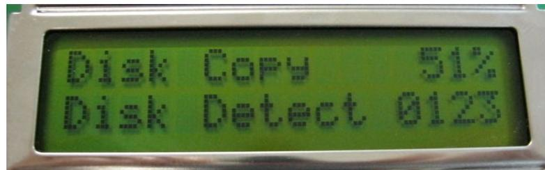
図 3-4: LCD によるコピー進捗状況の表示
