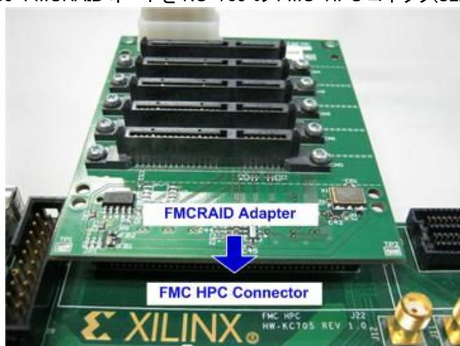
図 2-3: AB09-FMCRAID ボードを KC705 の FMC-HPC に接続
