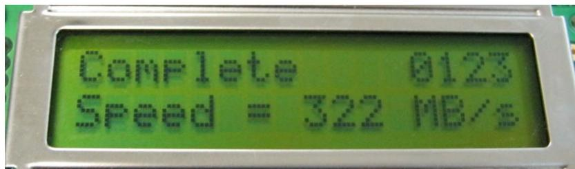
図 3-5: LCD のコピー完了表示
