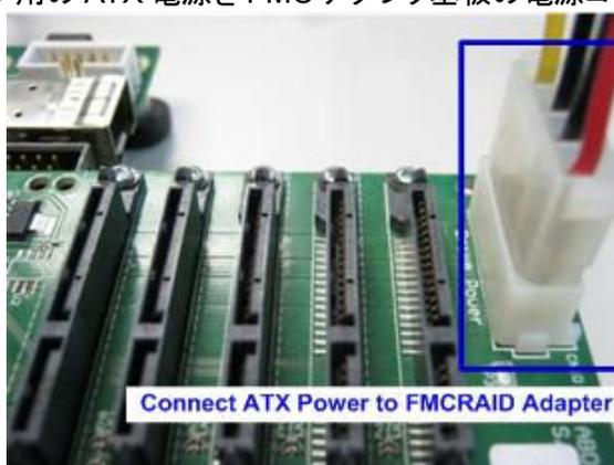
図 2-2: ATX 電源コネクタを AB09-FMCRAID アダプタへ接続
