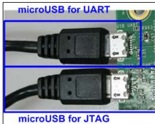
図 2-3: KCU105 ボードの場合 2つの miniUSB ケーブルを接続
