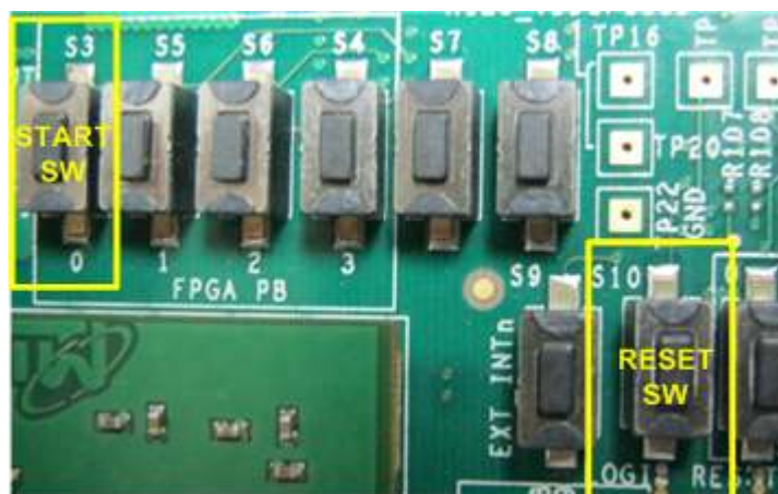
図 2-2: スタート SW(S3)とリセット SW(S10)の位置
