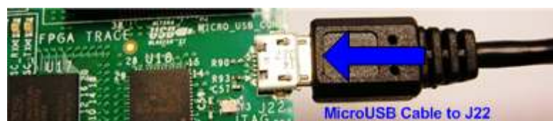
図 3-1: マイクロ USB ケーブルの接続
