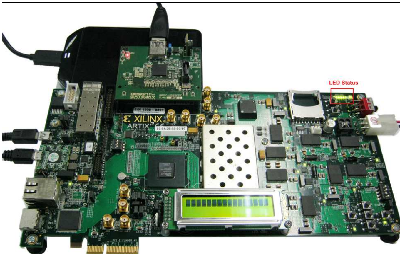
図 13: AC701 の実機接続
